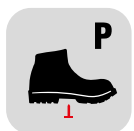
RESISTENZA ALLA PERFORAZIONE inserto metallico chiodo diametro 4,5 mm
